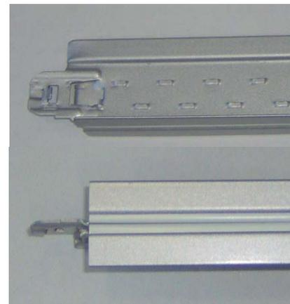
El ancho de los perfiles es de 24 mm. El conjunto conforma una cuadrícula de 600x600 mm diseñada para la colocación de las bandejas metálicas Módena de THU Perfil.
